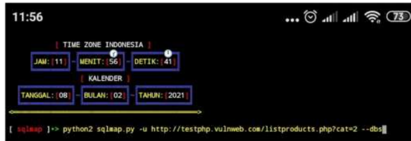
Gambar 5. Perintah untuk Pengujian Keamanan Basis Data Situs Web dengan SQLMap Tool di Termux
